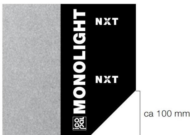
Figur 2: Undre våd i tvärskarv snedskärs enligt figuren.
